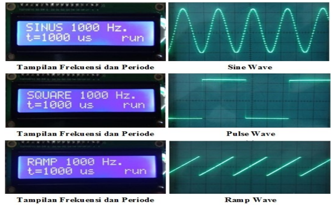
Gbr. 7 Gelombang Sinus, Kotak, Gergaji menggunakan Frekuensi 1000Hz
