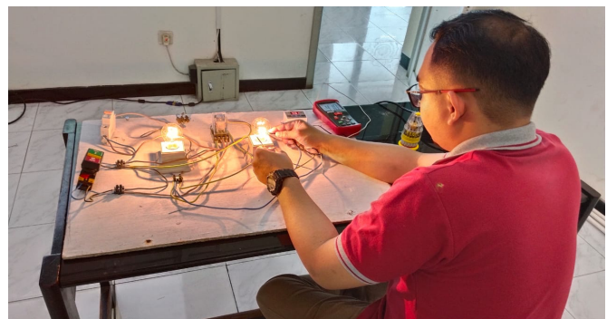
Gbr. 4 Percobaan Termostat Pengontrol Suhu
