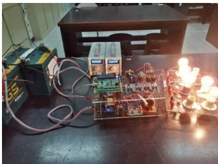
Gbr. 16 Pengujian SPWM-Inverter dengan beban lampu 5x100watt
