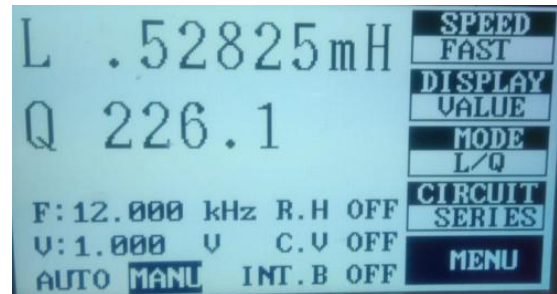
Gbr. 13 Pengujian Induktor
