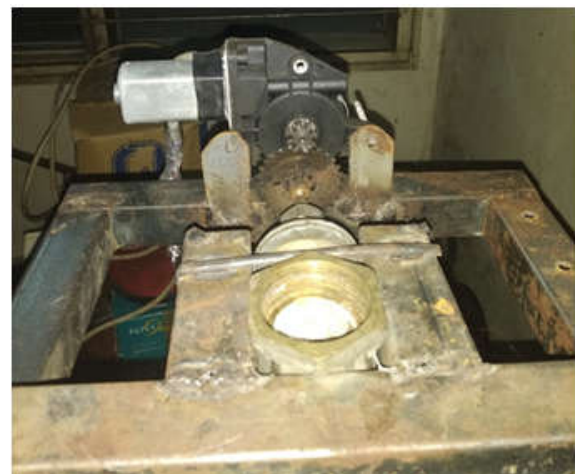
Gbr. 5 Pengerkan Kran Air
