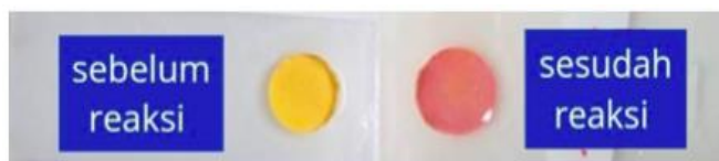
Gambar 10. Perubahan warna formalin menjadi formiat dengan indikator metil merah yang terimobilisasi matriks kertas whatman 40
