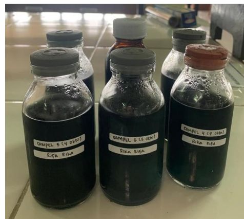
Gambar 1. Hasil hidrolisis Arthrospira platensis ( H_2SO_4 0,3 M, 100 °C, dan 90 menit) dengan bantuan gelombang mikro
