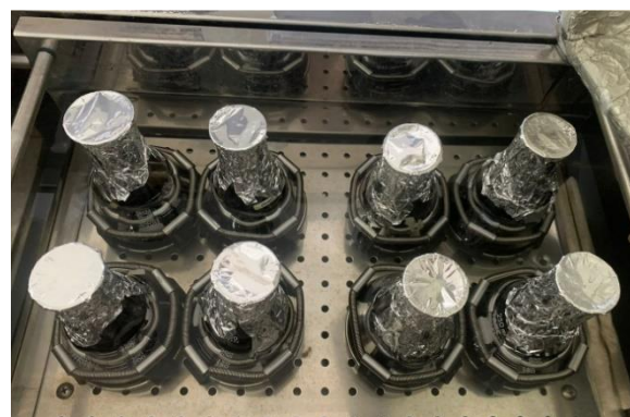
Gambar 2. Fermentasi dalam shaking water bath pada suhu 30 °C selama 96 jam
