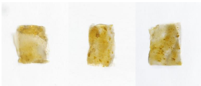
Gambar 1. Hasil bioplastik dengan konsentrasi pati biji melinjo dari kiri ke kanan: 5 gram; 10 gram; 15 gram
