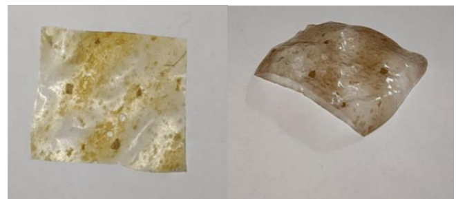
Gambar 6. Kiri: bentuk awal bioplastik pada suhu 32°C; kanan: bentuk bioplastik pada suhu 50°C
