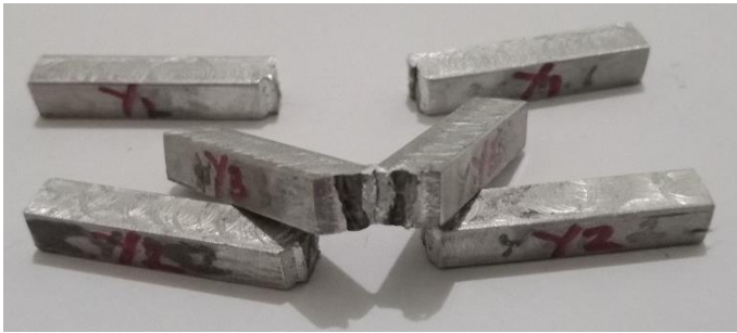
Gambar 7. Hasil uji Impak kelembaban 53%
