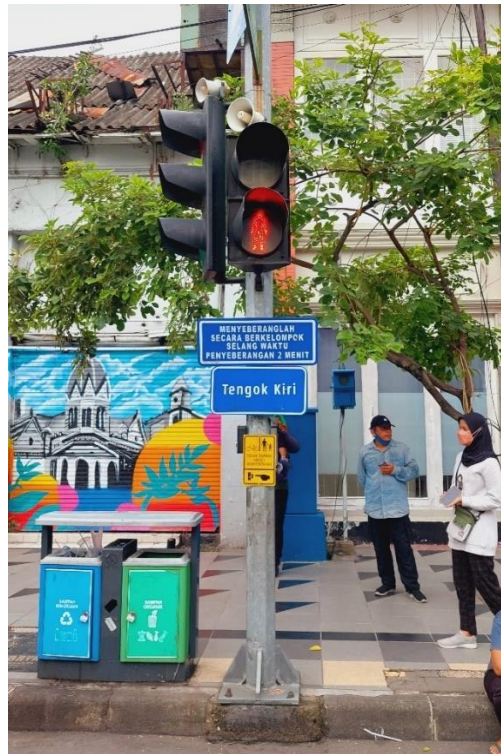
Gambar 2. Indikator sinyal lalu lintas dengan durasi lebih lambat dari 1 meter/detik
