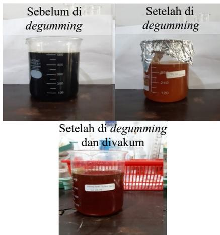
Gambar 1. Perubahan warna dari minyak biji nyamplung sebelum dan sesudah dilakukan proses degumming
