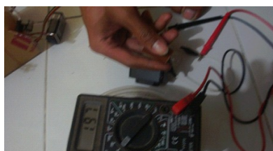
Gambar 12. Tegangan saat sensor tidak mendeteksi denyut jantung
