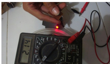
Gambar 11. Tegangan saat sensor mendeteksi denyut jantung
